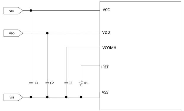
$V_{IREF}=V_{CC}-3V=13V-3V=10V$   $I_{REF}=10\mu A$   $R1=V_{IREF}/I_{REF}=1M\Omega \text{ for } V_{CC}=13 \text{ volts}$   $C1=C2=2.2\mu F$   $C4=1.0\mu F$
