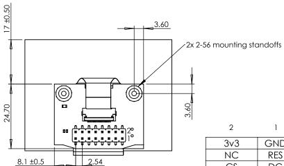
2 1 3v3 GND NC RES CS DC WR/RW RD/E D1 D0 D3 D2 D5 D4 D7 D6
